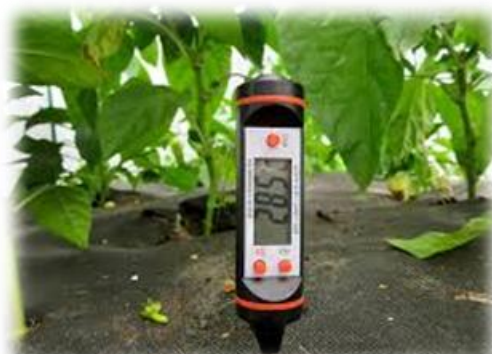
Monitoreo de la temperatura del suelo
