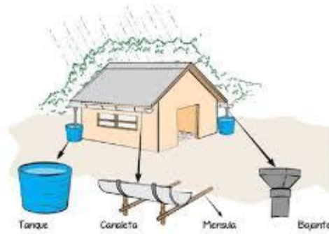
Captación del agua de lluvia
